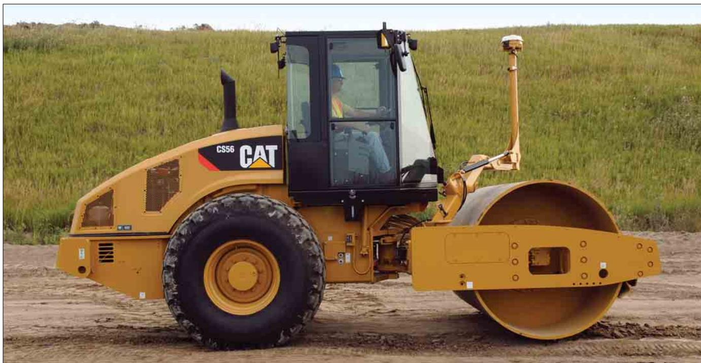
**Mappatura e misurazioni GPS.** Il sensore rileva la compattazione del terreno e correla i dati con la posizione GPS rilevata. Queste capacità migliorano la qualità del lavoro, riducendo i costi, la manodopera ed ottimizzando la produttività.
