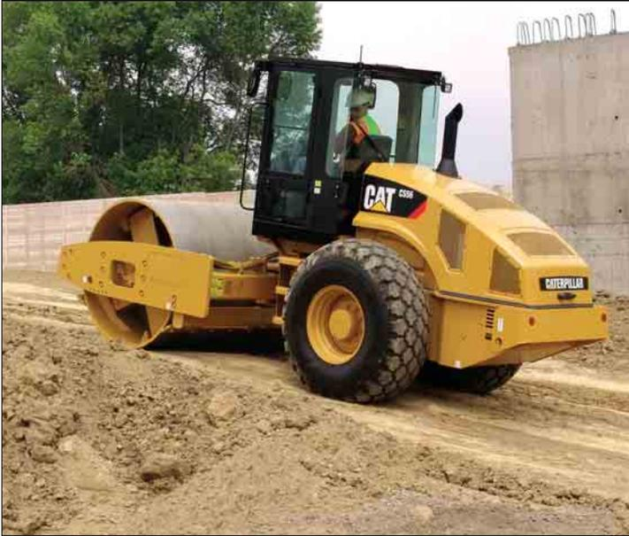
**Doppia trazione separata.** La doppia trazione separata, con due circuiti dedicati, permette di trasmettere coppie elevate sia al tamburo che ai pneumatici, indipendentemente. Nel caso di una perdita di trazione su un motore, vi è sufficiente flusso sul motore che non slitta da mantenere un'efficace trazione.
