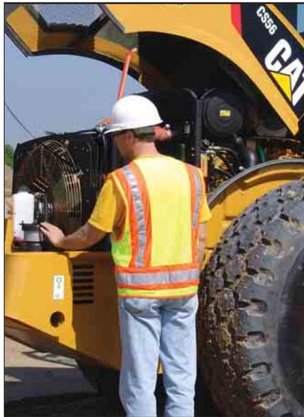
*Il cofano motore in vetroresina in un unico corpo si ribalta per consentire un facile accesso al motore ed al sistema di raffreddamento. I punti di manutenzione sono accessibili da terra e raggruppati su un lato della macchina.*
