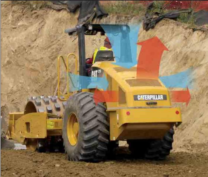
**Flusso d'aria ottimizzato.** Il sistema aspira aria fredda dalla parte centrale del cofano e scarica aria calda verso la parte posteriore
