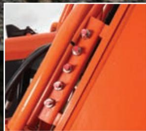
**Punti di ingrassaggio centralizzati**
