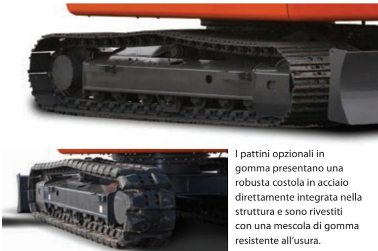
I pattini opzionali in gomma presentano una robusta costola in acciaio direttamente integrata nella struttura e sono rivestiti con una miscela di gomma resistente all'usura.
