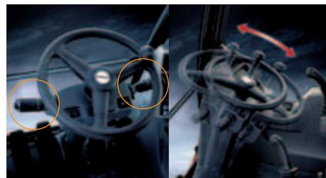
Piantone dello sterzo e pulsante di controllo velocità di traslazione
