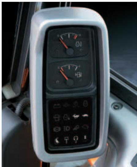
Pannello di strumentazione di tipo fisso
