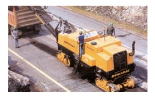
Il Leggendario modello Dynapac PL 2000, sviluppato nel 1978, è stato in tutto il mondo un esempio di fresatrice a freddo all'avanguardia con caratteristiche eccezionali come i sistemi di carico anteriore ed il sistema di livellamento combinati all'estrema facilità d'uso ed alla massima economia di esercizio. Il numero elevato di fresatrici PL 2000 ancora in servizio è una sicura testimonianza dell'eccellente affidabilità e della lunga durata di questo vecchio modello.
