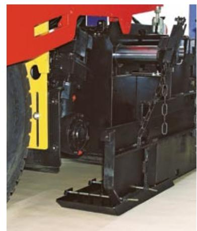
È possibile scegliere altri articoli optional, come ad esempio i riduttori di stesa, i bordi conici, le protezioni laterali pieghevoli e vari sistemi di livellamento.
