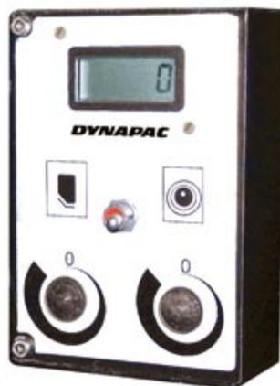
Le frequenze del tamper e della vibrazione sono semplici da regolare e sono visualizzate su di un display di facile lettura (optional).
