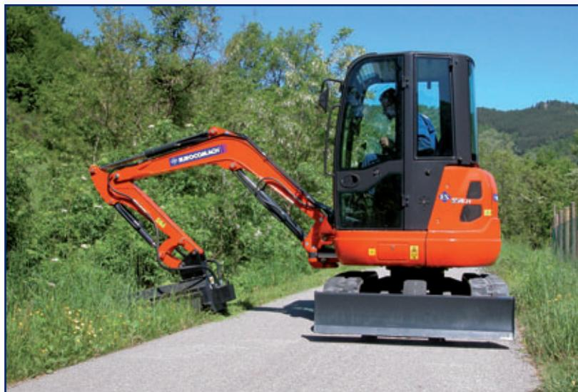
Grazie ad un impianto idraulico ausiliario sarà inoltre possibile utilizzare nel modo più corretto e funzionale una testata trinciante.
