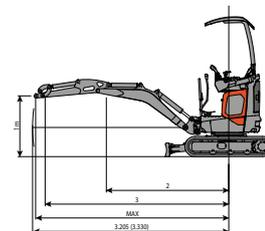
La capacità di sollevamento è basata sulla norma ISO 10567 e non eccede oltre il 75% del carico statico di ribaltamento o dell'87% della capacità di sollevamento idraulico della macchina.
