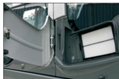
Le larghe porte consentono di accedere da terra al filtro del carburante, al separatore dell'acqua e al filtro dell'olio motore. Un comodo corrimano, dei gradini e le piastre antiscivolo conducono al carter motore. La coppa dell'olio motore è provvista di un attacco per lo spurgo: Durante lo scarico, al raccordo viene collegato un tubo flessibile. Il tappo per lo spurgo è affidabile ed evita perdite di olio e atti vandalici.
