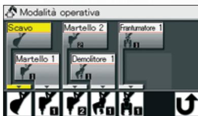
Quando si sostituisce un accessorio, la portata dell'olio può essere regolata automaticamente toccando il display di selezione delle modalità di lavoro sul monitor LCD. Se necessario è possibile apportare piccole correzioni alla portata dell'olio.
