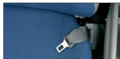
Altre funzioni includono la cintura di sicurezza avvolgibile, il martelletto frangivetro e l'interruttore per l'arresto del motore in caso di emergenza. Una leva per l'esclusione dei comandi previene movimenti accidentali. È disponibile in opzione una struttura FOPS (Falling Object Protective Structure, struttura di protezione in caso di caduta di materiali). I cristalli della cabina sono disponibili in vetro di sicurezza laminato oppure temprato.
