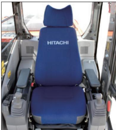
Sono inclusi i braccioli larghi regolabili e la cintura di sicurezza retrattile. La corsa breve delle leve consente di svolgere operazioni protratte con un minore affaticamento. Tre interruttori opzionali possono essere montati sulla leva per azionare gli accessori (tranne le benne). La cabina è pressurizzata per impedire l'ingresso della polvere. Rumore e vibrazioni sono ridotti al minimo grazie ai supporti elastici, riempiti di olio silconico, su cui poggia la cabina.
