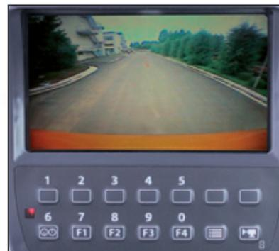
Il monitor LCD a colori widescreen, insieme alla videocamera per la retrovisione sul contrappeso, fornisce una visuale dell'area posteriore. La videocamera per la retrovisione si attiva automaticamente durante la traslazione, ma può anche essere attivata manualmente con il selettore sul monitor.
