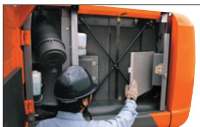
Il radiatore dell'olio, quello dell'acqua e l'intercooler sono disposti in parallelo invece che nel tradizionale schema orizzontale. Questa disposizione parallela rende decisamente più semplice la pulizia nell'area intorno al motore. Il condensatore del climatizzatore può essere aperto per pulire facilmente il condensatore e il radiatore dell'acqua retrostante.
