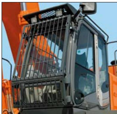
La cabina H/R sfrutta il cristallo anteriore rinforzato e la struttura FOPS\* del tettuccio come protezione dalla caduta di oggetti. Il cristallo anteriore, realizzato in vetro di sicurezza laminato, è montato in modo da impedire l'ingresso di sporcizia e detriti. La cabina provvista di griglia a copertura totale è conforme ai requisiti OPG\*\*(livello II) secondo ISO.
