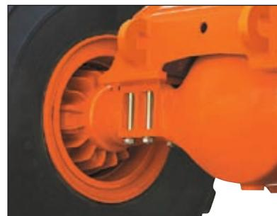
I freni a disco in bagno d'olio montati esternamente e sigillati offrono un'elevata forza frenante e impediscono la penetrazione di sporcizia. Sono presenti linee doppie indipendenti per gli assali anteriore e posteriore, al fine di incrementare la sicurezza.
