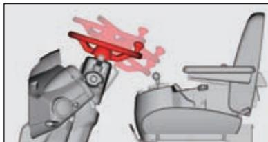
Il piantone dello sterzo è inclinabile e telescopico per essere regolato in base alla corporatura dell'operatore, offrendo un posizionamento e un utilizzo confortevoli.
