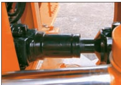
I giunti universali sono sigillati ermeticamente per prolungare gli intervalli di lubrificazione fino a 12.000 ore, semplificando la manutenzione e incrementando la durata.
