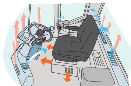
Il condizionatore/riscaldamento è controllato in modo automatico e termostatico per incrementare il comfort dell'operatore. I bocchettoni consentono una buona circolazione dell'aria all'interno e lo sbrinamento in qualunque stagione. La cabina è pressurizzata per impedire la penetrazione di sporcizia.
