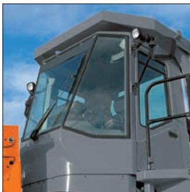
La cabina offre un'elevata visibilità con specchietti retrovisori interni ed esterni. Il parabrezza è realizzato con vetro piatto montato con guarnizioni in gomma per semplificarne la sostituzione. La cabina poggia su supporti viscosi che assorbono le vibrazioni e la rumorosità offrendo maggiore comfort all'operatore.
