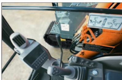
Il monitor LCD a colori in cabina indica la temperatura del refrigerante, il livello del carburante e i dati sulla manutenzione. Consente inoltre la rapida regolazione dell'attrezzo. Il display può essere regolato per il turno diurno o notturno.
