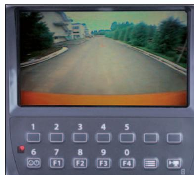
L'LCD a colori widescreen, in combinazione con la videocamera di retrovisione posta sul contrappeso, fornisce una vista ottimale dell'area posteriore. La videocamera di retrovisione si attiva automaticamente durante gli spostamenti in retromarcia e può essere attivata anche manualmente tramite un interruttore di selezione sul monitor.
