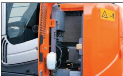
Il radiatore dell'olio, quello dell'acqua e l'intercooler sono disposti in parallelo invece che nel tradizionale schema orizzontale. Questa disposizione parallela rende decisamente più semplice la pulizia nell'area intorno al radiatore.
