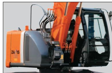
Le larghe porte consentono di accedere, da terra, al filtro del combustibile, al separatore dell'acqua e al filtro dell'olio motore. Un comodo corrimano, dei gradini e le piastre antisdrucchiole conducono al cofano del motore. La coppa dell'olio motore è provvista di un attacco per lo spurgo: per eseguire lo spurgo all'attacco viene collegato un flessibile di drenaggio. Il tappo per lo spurgo è affidabile ed evita perdite di olio e atti vandalici.
