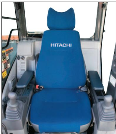
Sono inclusi i braccioli larghi regolabili e la cintura di sicurezza retrattile. La corsa breve delle leve consente di svolgere operazioni protratte con un minore affaticamento. Tre interruttori opzionali possono essere montati sulla leva per azionare gli accessori (tranne le benne). La cabina è pressurizzata per impedire l'ingresso della polvere. Rumore e vibrazioni sono ridotti al minimo grazie ai supporti elastici, riempiti di olio silconico, su cui poggia la cabina.
