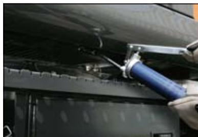
Il punto per l'ingrassaggio di tutta la ralla a sfere è stato ridisegnato e posizionato sotto la cabina. In questo modo, l'ingrassaggio e la manutenzione risultano facilitati.
