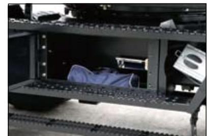
L'unità è dotata di una cassetta attrezzi di grande capacità ed abbastanza ampia da riporre un contenitore metallico. La cassetta può essere utilizzata come uno spazio versatile per riporre attrezzi e pistole di ingrassaggio.
