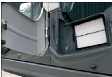
Il filtro per l'aria esterna del climatizzatore è stato spostato e invece che alle spalle del sedile dell'operatore si trova sul lato dov'è lo sportello della cabina. In questo modo è facile pulire e sostituire il filtro, come pure il filtro di circolazione dell'aria all'interno della cabina.
