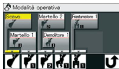
Quando si sostituisce un accessorio, la portata dell'olio può essere regolata automaticamente tramite il display di selezione della modalità di lavoro sul monitor LCD. Se necessario è possibile apportare correzioni minime alla portata dell'olio.
