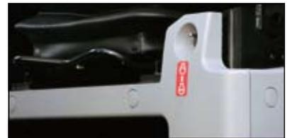
**Leva di esclusione circuito di pilotaggio**
