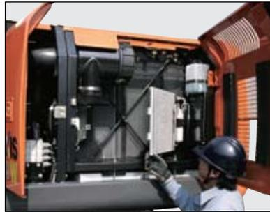
Il radiatore dell'olio, quello dell'acqua e l'intercooler sono disposti in parallelo invece che nel tradizionale schema orizzontale. Questa disposizione parallela rende decisamente più semplice la pulizia nell'area intorno al motore. Il condensatore del climatizzatore può essere aperto per pulire facilmente il condensatore e il radiatore dell'acqua retrostante.
