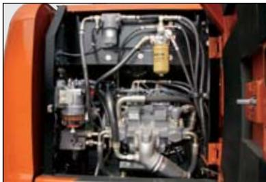
Le larghe porte consentono di accedere, da terra, al filtro del carburante, al separatore dell'acqua e al filtro dell'olio motore. L'olio idraulico può essere usato per massimo 5.000 ore.
