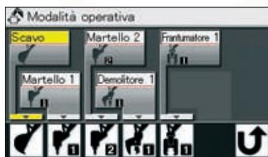
Quando si sostituisce un accessorio, la portata dell'olio può essere regolata automaticamente toccando il display di selezione delle modalità di lavoro sul monitor LCD. Se necessario è possibile apportare correzioni minime alla portata dell'olio.
