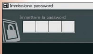
Onde evitare furti e atti vandalici, l'immobilizzatore elettronico richiede l'inserimento di un codice crittografato nel monitor multifunzione ogni volta che si avvia il motore.
