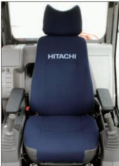
Sono inclusi i braccioli larghi regolabili e la cintura di sicurezza retrattile. La corsa breve delle leve consente di svolgere operazioni protratte con un minore affaticamento. Tre interruttori opzionali possono essere montati sulla leva per azionare gli accessori (tranne le benne). La cabina è pressurizzata per impedire l'ingresso della polvere. Rumore e vibrazioni sono ridotti al minimo grazie ai supporti elastici, riempiti di olio silconico, su cui poggia la cabina.
