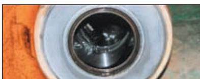
Rivestimento termico in carburo di tungsteno con deposizione spray
