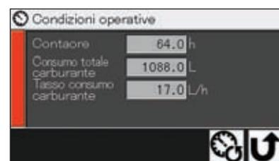
Viene calcolato il consumo di carburante per ogni ora di funzionamento e il risultato viene visualizzato sul monitor LCD. Questo dato suggerisce i tempi di rifornimento carburante e fornisce un'indicazione sulle operazioni a risparmio energetico e la gestione efficace dei lavori.
