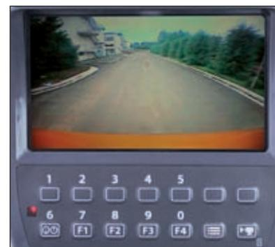
Il monitor LCD a colori widescreen, insieme alla videocamera per la retrovisione sul contrappeso, fornisce all'operatore una vista completamente libera dell'area posteriore. La videocamera per la retrovisione si attiva automaticamente durante la traslazione, ma può anche essere attivata manualmente con l'interruttore di selezione del monitor.
