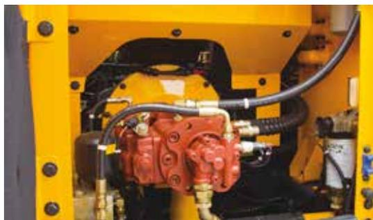
Per ottenere la massima precisione, Hyundai ha riprogettato l'impianto idraulico per offrire all'operatore la massima maneggevolezza e manovrabilità. Le valvole a bobina nella valvola di controllo sono progettate per fornire una portata più precisa a ciascuna funzione, con uno sforzo minore.
