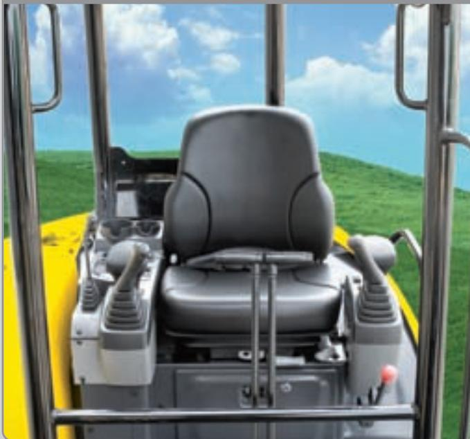
Un ampio tettuccio assicura una visibilità completa in tutte le direzioni. Il sedile a sospensione di elevata qualità assorbe la maggior parte delle vibrazioni prodotte durante lo scavo, assicurando all'operatore il massimo comfort.
