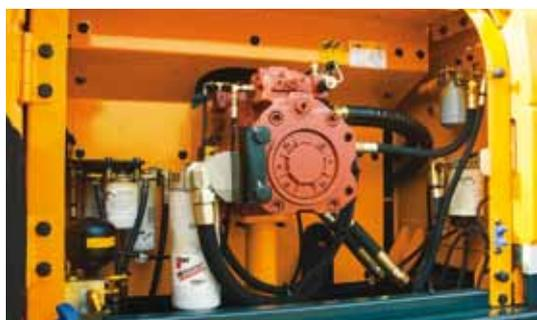
Per ottenere la massima precisione, Hyundai ha riprogettato l'impianto idraulico per offrire all'operatore la massima maneggevolezza e manovrabilità. Le valvole a bobina nella valvola di controllo sono progettate per fornire una portata più precisa a ciascuna funzione, con uno sforzo minore.
