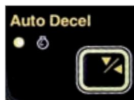
Quando le valvole di comando a distanza rimangono in posizione di folle per più di 4 secondi, il controller CPU dà istruzioni all'attuatore
