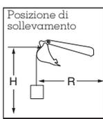
La capacità di sollevamento è basata sulla norma ISO 10567 e non eccede oltre il 75% del carico statico di ribaltamento o dell'87% della capacità di sollevamento idraulico della macchina.
