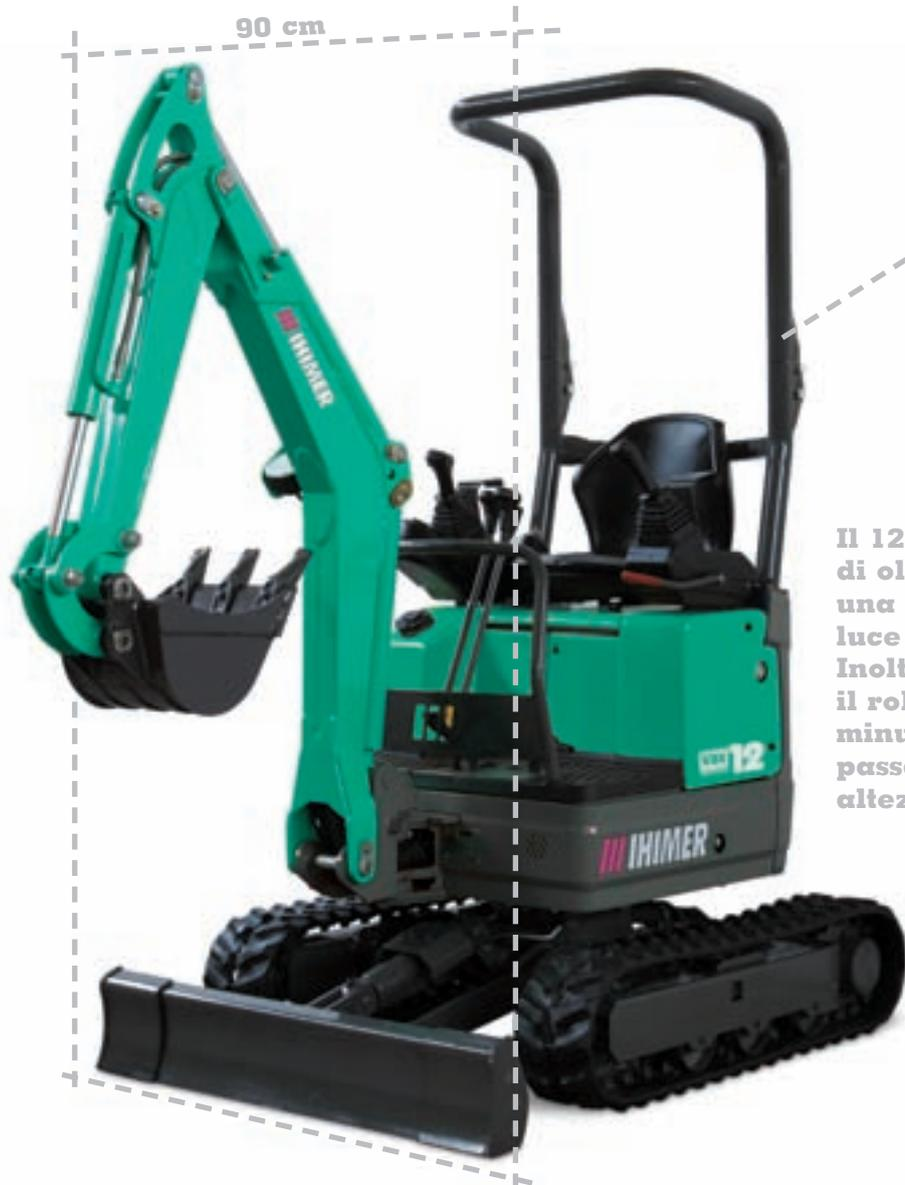
**Il 12VXE è in grado di oltrepassare una porta con luce minore di 90 cm. Inoltre si può smontare il rollbar in pochi minuti per facilitare passaggi sotto altezze minime.**
