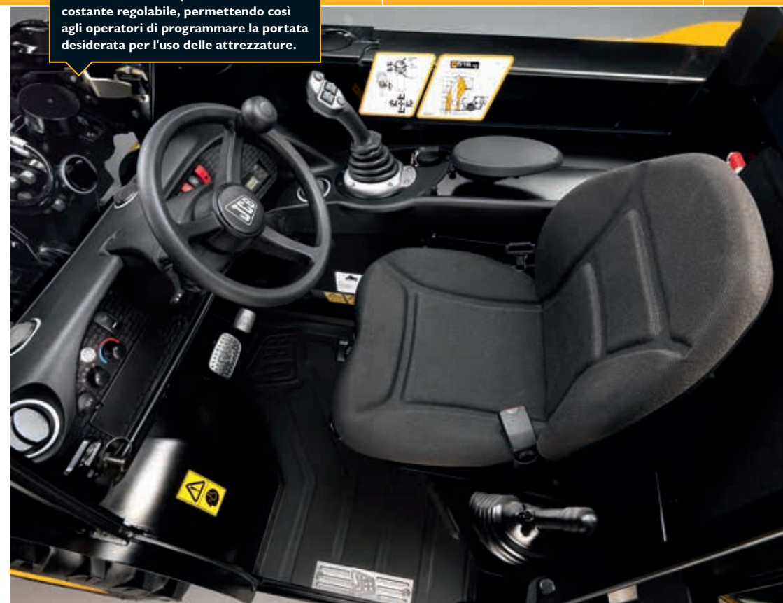
Il sistema adattivo di controllo carico JCB protegge automaticamente dal ribaltamento in avanti durante la movimentazione di carichi pesanti.
