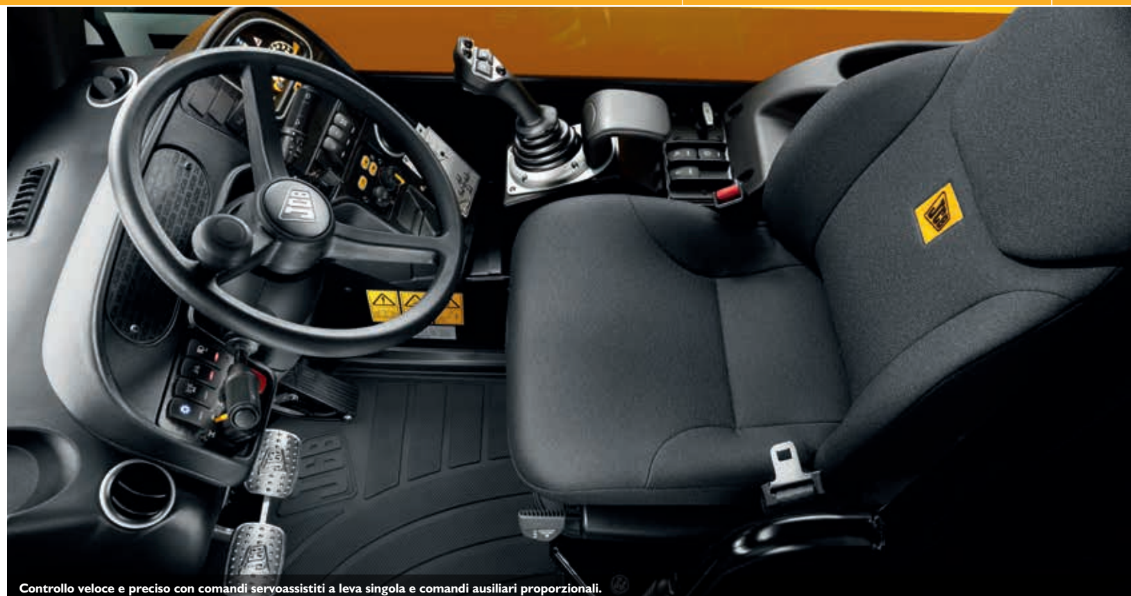
Controllo veloce e preciso con comandi servoassistiti a leva singola e comandi ausiliari proporzionali.
