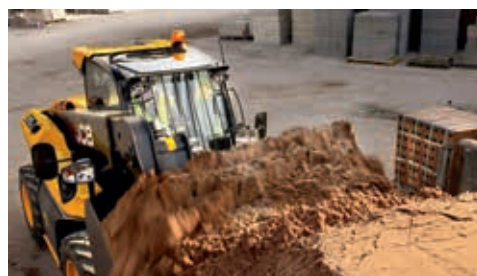
Il sistema adattivo di controllo carico JCB protegge automaticamente dal ribaltamento in avanti durante la movimentazione di carichi pesanti.
