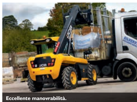
Il sistema adattivo di controllo carico JCB protegge automaticamente dal ribaltamento in avanti durante la movimentazione di carichi pesanti.
