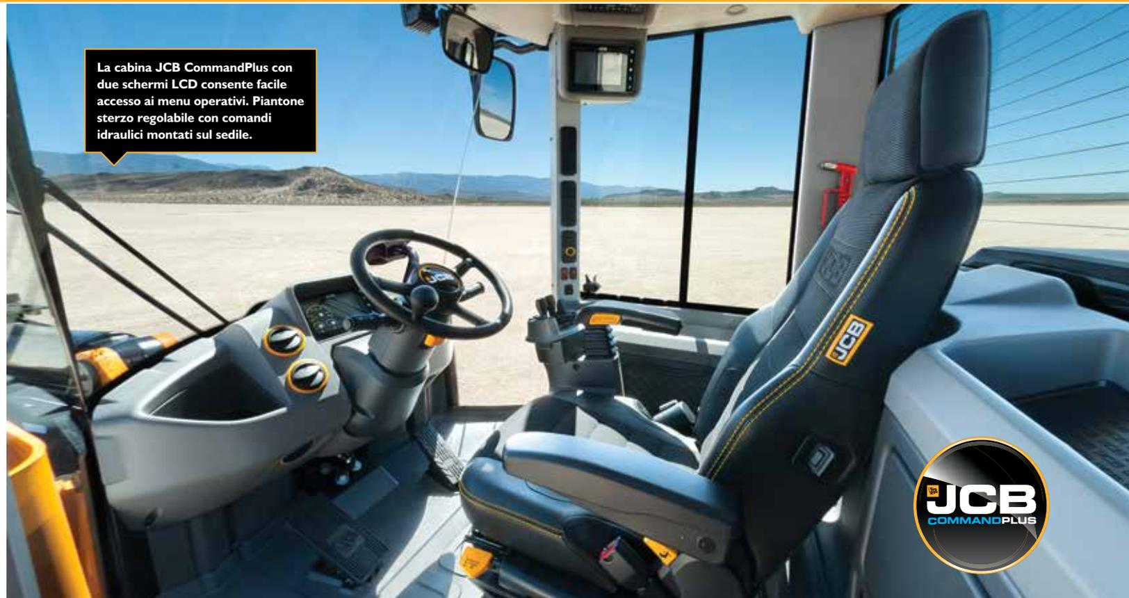
La cabina JCB CommandPlus con due schermi LCD consente facile accesso ai menu operativi. Piantone sterzo regolabile con comandi idraulici montati sul sedile.
