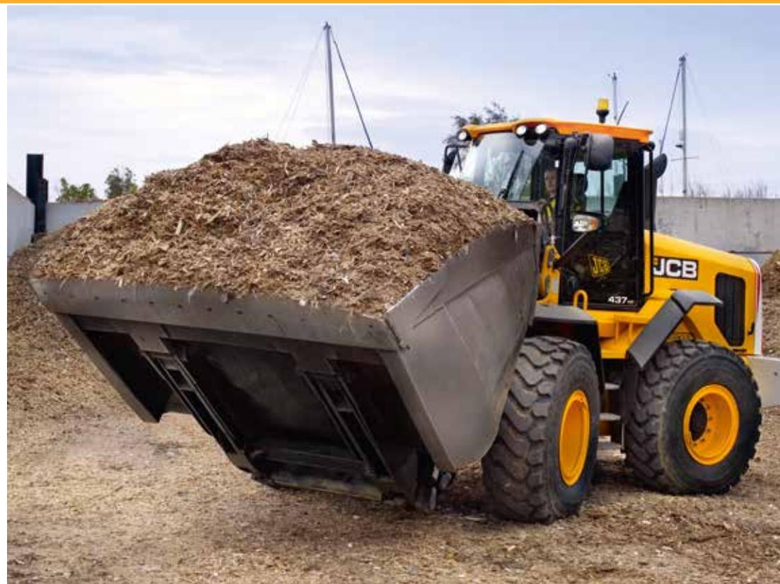
Pala per rifiuti ad elevata capacità.
