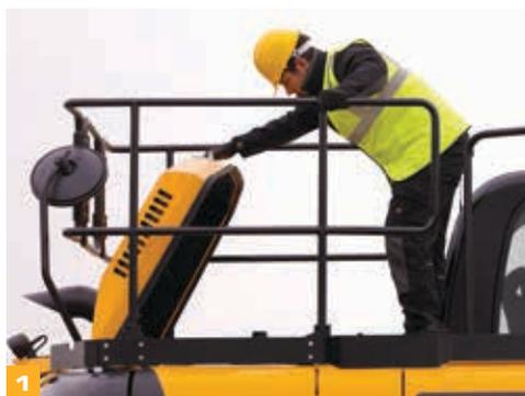
**1** Il cofano dei modelli JS115/130/145 si apre longitudinalmente verso il retro per garantire un accesso alla manutenzione del motore agevole e sicuro.
