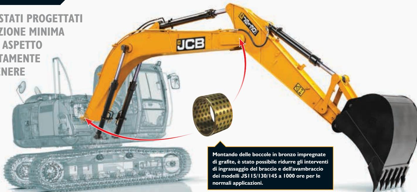
Montando delle boccole in bronzo impregnate di grafite, è stato possibile ridurre gli interventi di ingrassaggio del braccio e dell'avambraccio dei modelli JS115/130/145 a 1000 ore per le normali applicazioni.
