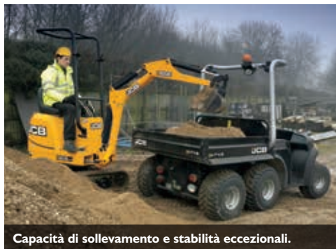
Le dimensioni compatte e la rotazione posteriore minima consentono di lavorare in spazi ristretti.
