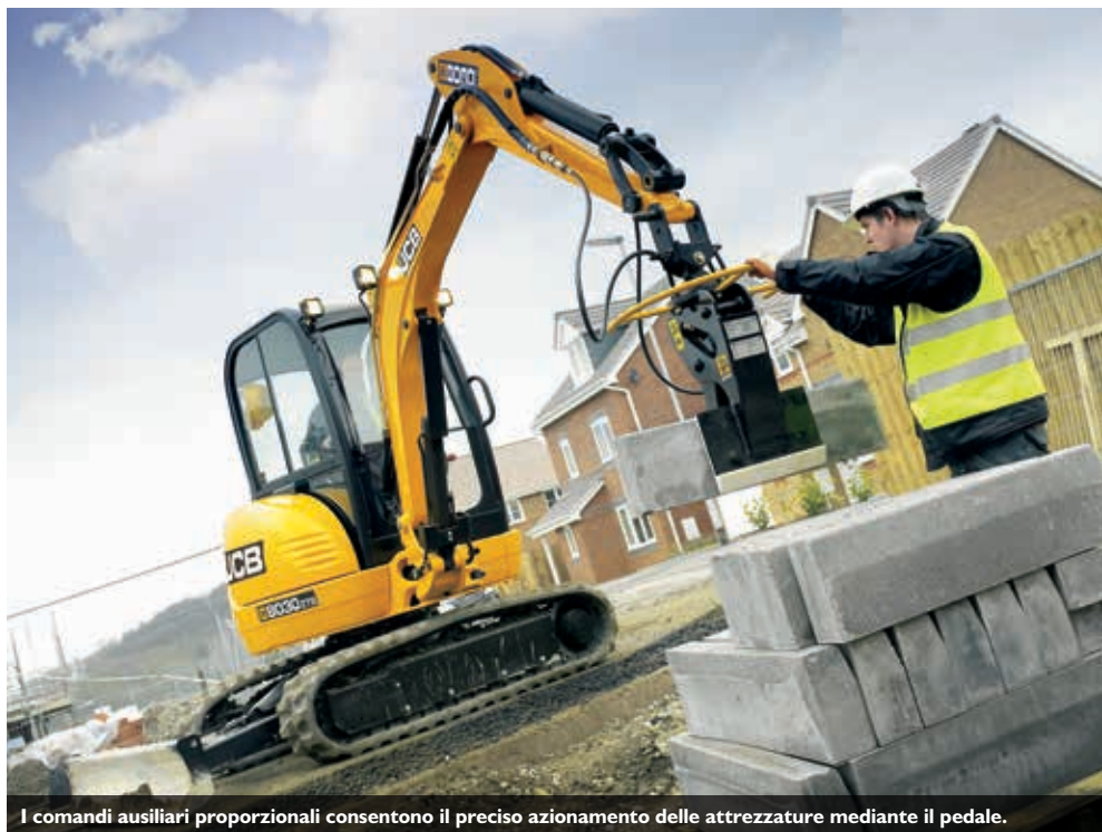
I raccordi a sgancio rapido di serie sul circuito ausiliario evitano perdite d'olio e contaminazione durante la sostituzione delle attrezzature.
