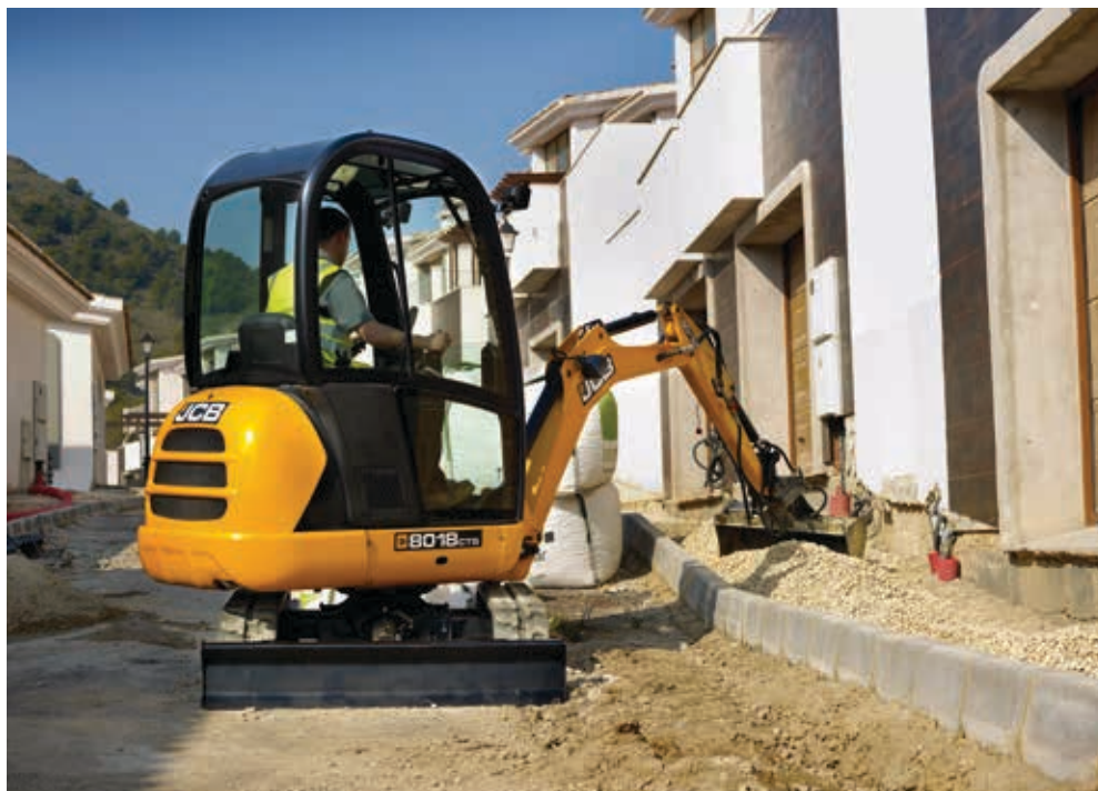
La nuova geometria di scavo offre sbraccio, altezza di carico e profondità di scavo maggiori.
