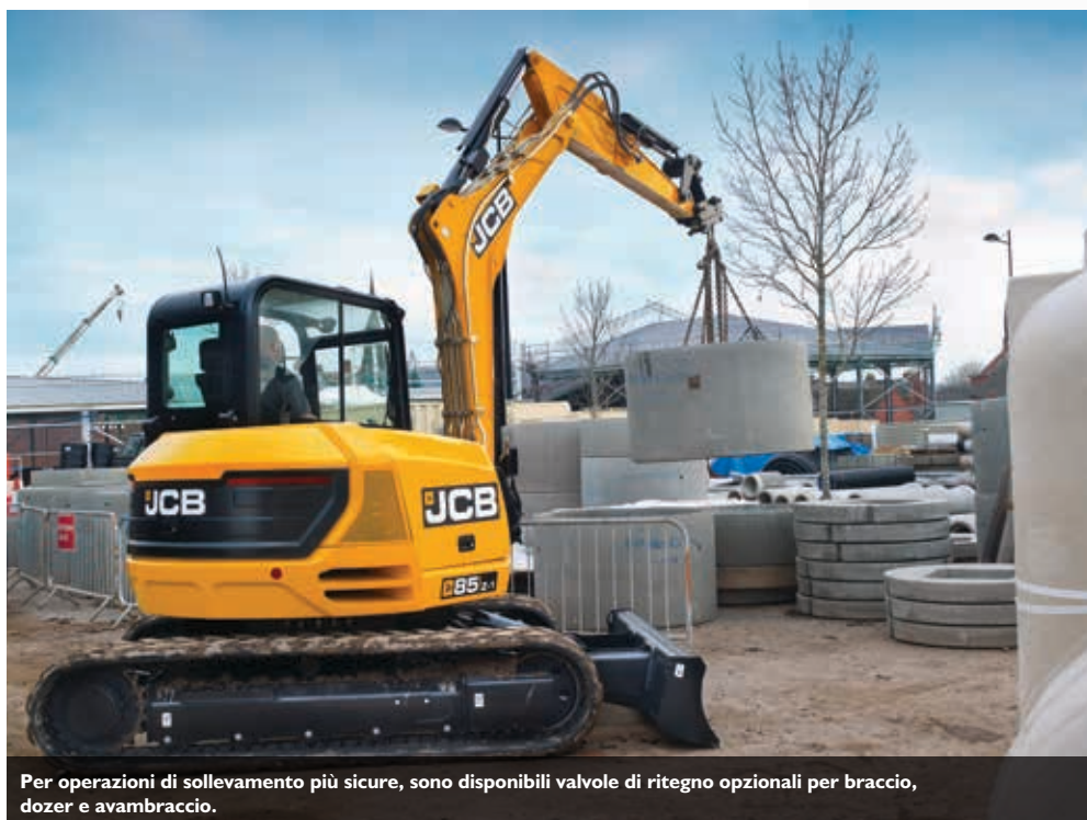
La protezione heavy-duty del cilindro del braccio assicura eccellente protezione durante il carico.
