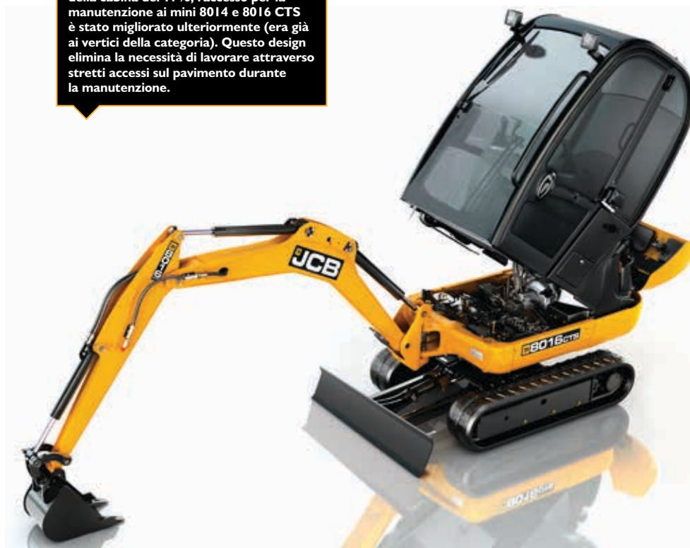
Il cofano posteriore ad ampia apertura è sostenuto da un ammortizzatore a gas che assicura il semplice accesso per i controlli periodici.
