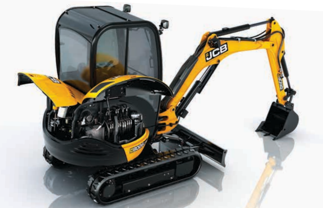
Il sistema di ingrassaggio dall'estremità dei perni facilita e velocizza la lubrificazione del gruppo di scavo. I pannelli di accesso per la manutenzione sono ampi e supportati con ammortizzatori a gas per un accesso eccellente per i controlli periodici.
