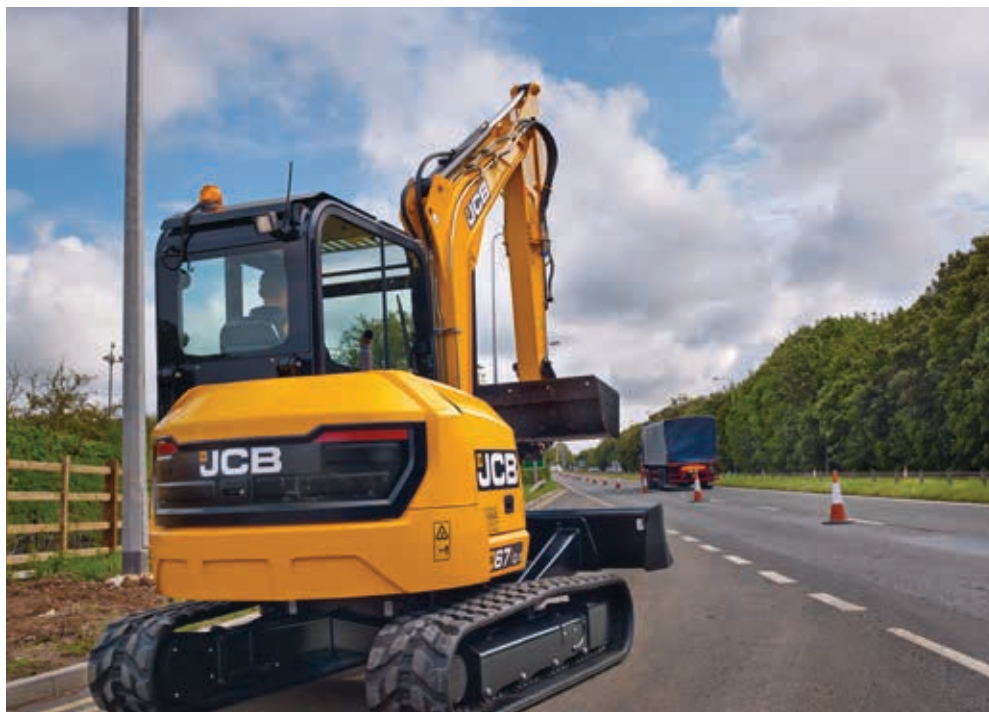
Forza di trazione e velocità di traslazione di 8 km/h, ai vertici della categoria.
