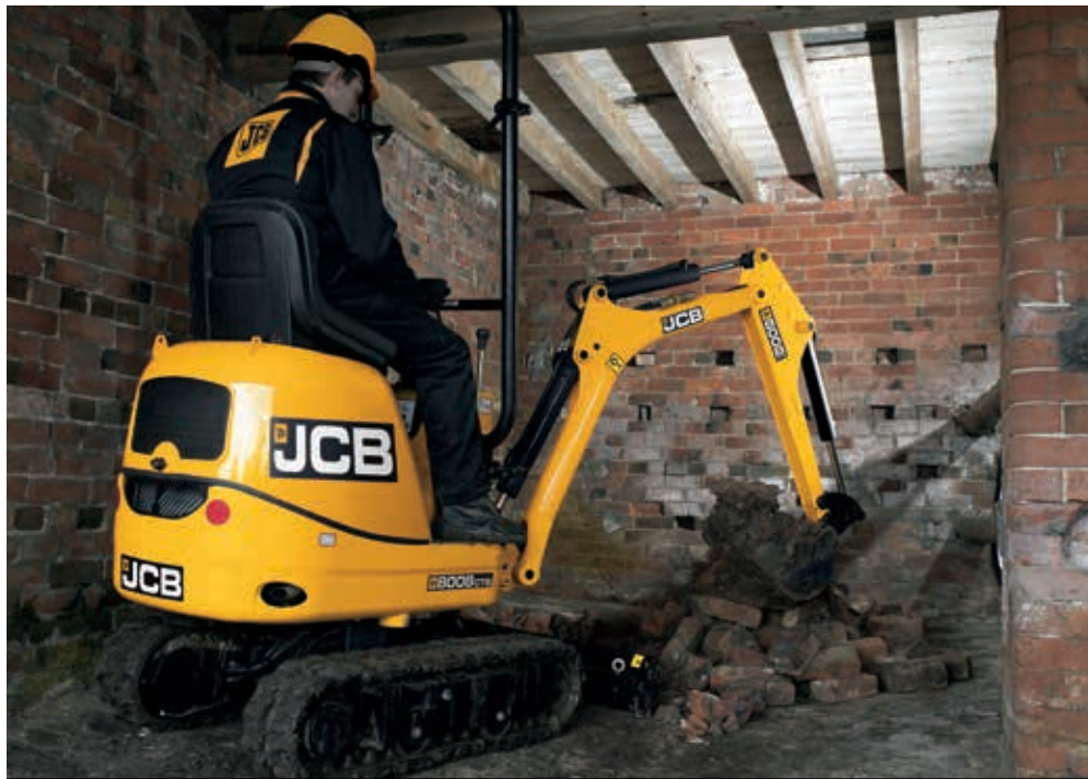
Le dimensioni compatte e la rotazione posteriore minima consentono di lavorare in spazi ristretti.
