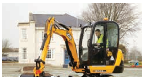
Il nuovo distributore idraulico consente di mantenere una traiettoria rettilinea anche azionando contemporaneamente altre funzioni dell'escavatore, aumentando così la produttività.
