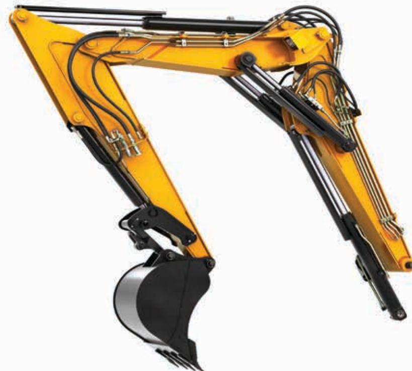
Per ottenere capacità di sollevamento e stabilità massime, scegliete il modello 86c con il braccio opzionale TAB (triplice articolazione) che offre una più ampia geometria di lavoro, uno sbraccio maggiore, la possibilità di scavare più vicino alla macchina e maggiori altezze di carico.
