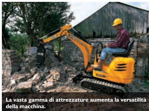
Le dimensioni compatte e la rotazione posteriore minima consentono di lavorare in spazi ristretti.
