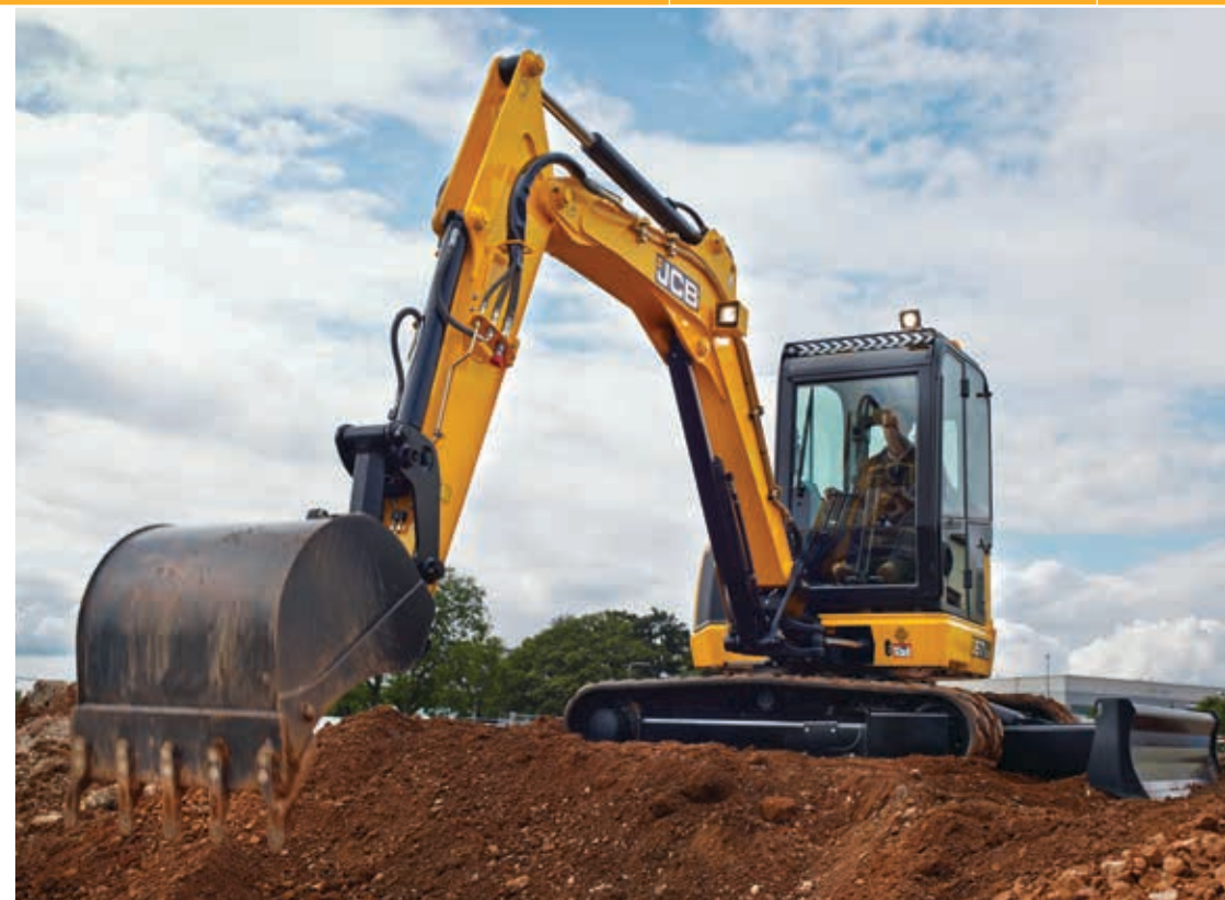
Carrozzeria realizzata esclusivamente con acciaio pressato senza plastica.
