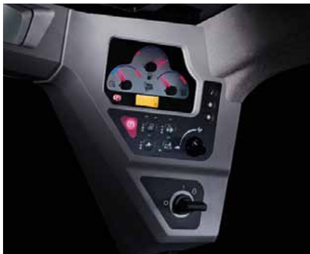
Il quadro comandi destro comprende le funzioni diagnostiche della macchina, l'acceleratore elettronico e l'accensione della minipala.
