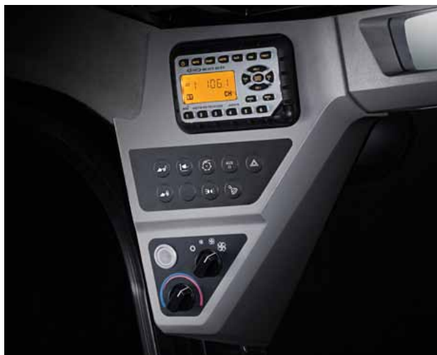
I comandi della macchina sono disposti in posizione strategica sul padiglione all'altezza degli occhi dell'operatore.
