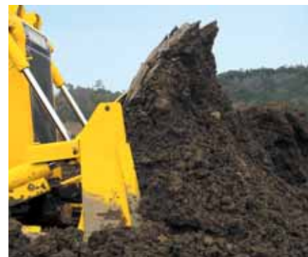
La lama Sigmadozer® offre una maggiore capacità di materiale
