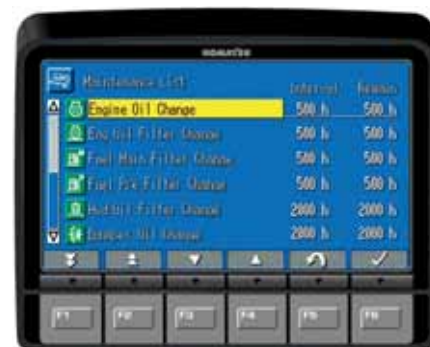
Monitor di controllo manutenzione
