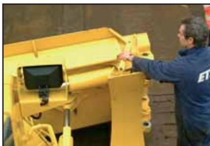
Bloccaggio delle estremità laterali.
