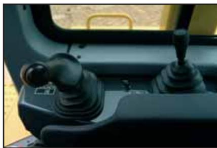
Joystick di comando e leva comando ripper
