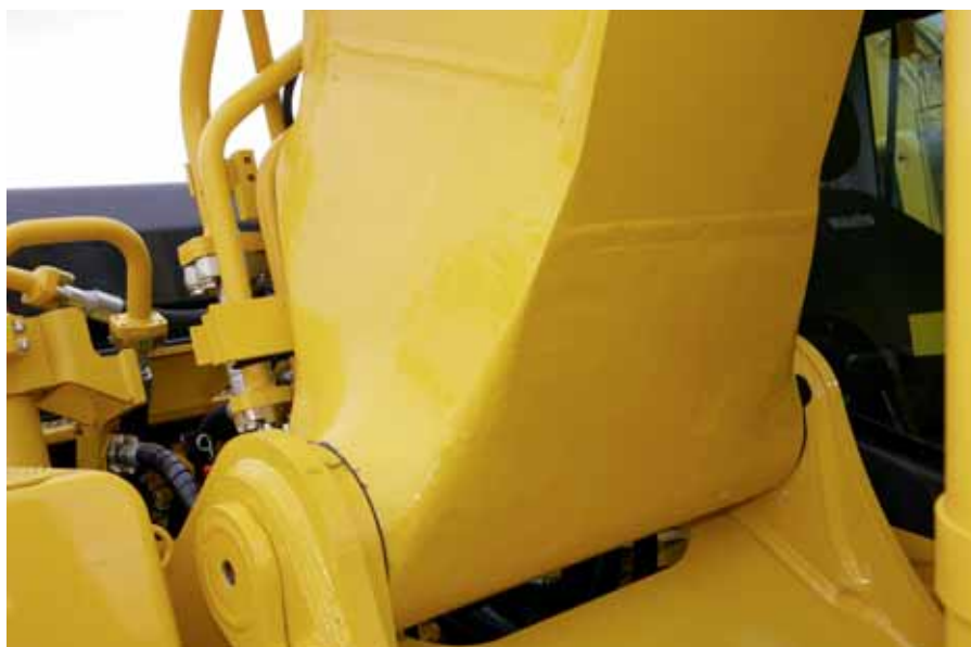
Base del braccio in fusione d'acciaio
