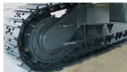
Protezioni resistenti dei motori di traslazione
