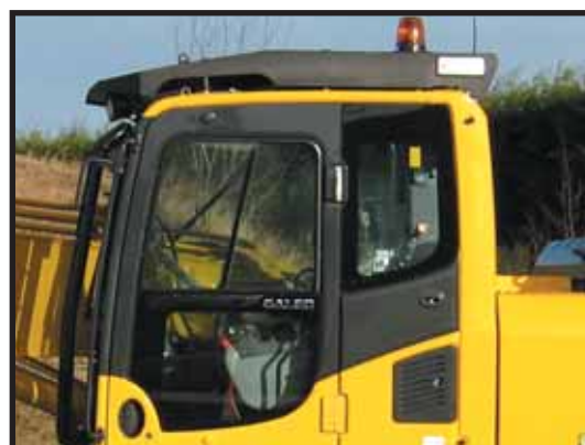
Protezioni OPG livello 2, conformi alle norme ISO 10262
