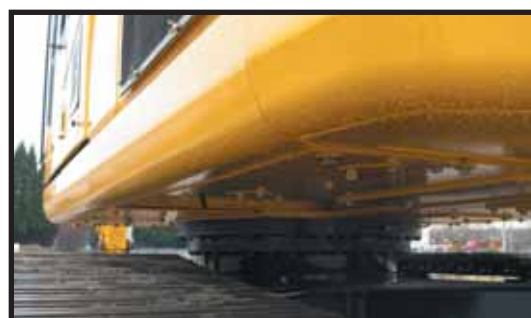
Sotto alla torretta sono installate robuste protezioni che offrono una notevole resistenza al danneggiamento dovuto ai detriti.
