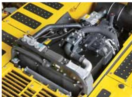
Il filtro olio motore e il drenaggio del carburante sono installati a distanza per facilitare l'accesso.
