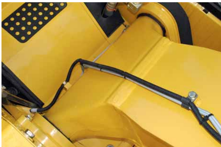
Base del braccio in fusione d'acciaio
