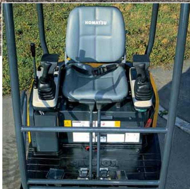
La seconda velocità di traslazione (opzionale) è azionabile tramite un pulsante posizionato sul pannello di controllo, dove si possono monitorare tutte le principali funzioni della macchina.
