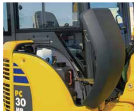
Cofano anteriore: accesso al serbatoio carburante
