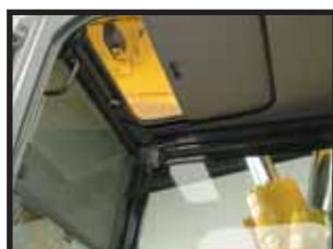
Ampio tettuccio trasparente con parasole integrato
