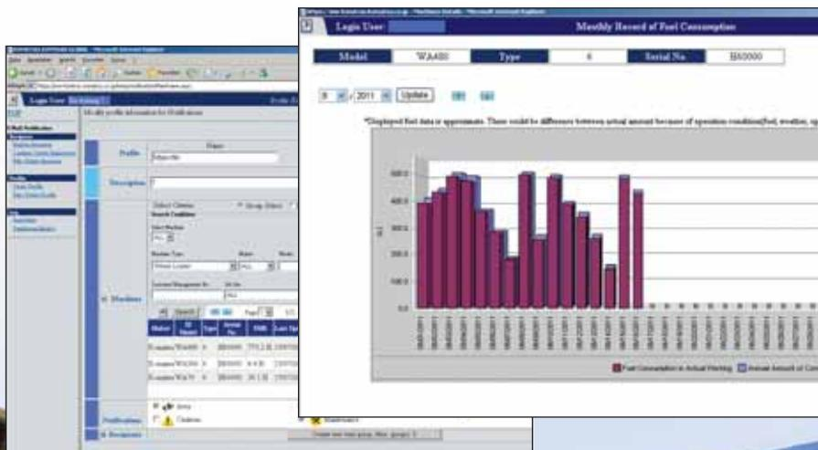
Un semplice grafico illustra il consumo di carburante della macchine e vi aiuta a calcolare i costi totali di un cantiere e a programmare in modo efficiente le consegne di carburante.
