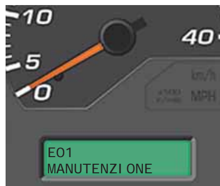
Sistema di monitoraggio e diagnostico EMMS
