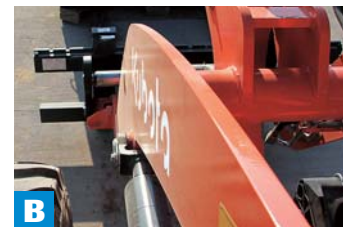
Vue sur les point d'ancrage du lève palette
