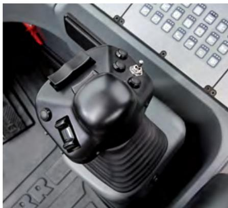
Leva di comando Liebherr, comandata elettroidraulicamente, regolabile tramite il touchscreen Liebherr
