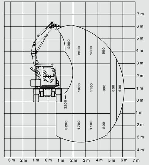
Carichi in Kg in configurazione ottimale dell'equipaggiamento
