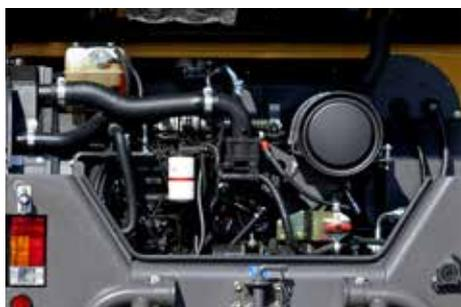
Il motore montato trasversalmente e due grandi botole sotto il telaio permettono un facile accesso per le operazioni di manutenzione.
