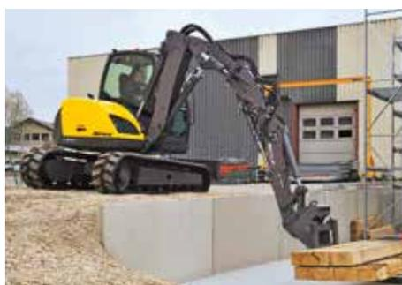
**Movimentazione con forche sotto il livello del terreno, unica per un escavatore.**
