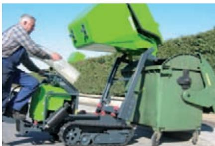
L'efficienza nel trasporto degli inerti abbinata alla versatilità dello scarico in altezza.
