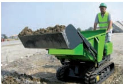
Il vantaggio della pala frontale a sollevamento idraulico per il carico del materiale.
