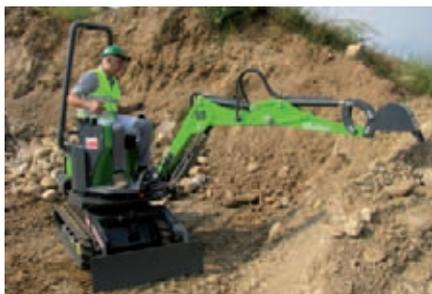
Potenza, dimensioni ridotte ed elevata velocità operativa: la soluzione ideale per lo scavo di precisione in luoghi angusti. È completo di lama frontale da reinterro con funzione stabilizzatrice.
