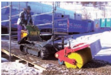
Il vantaggio della spazzola rotante ad angolazione variabile. È compatibile con il sistema di aggancio rapido.
