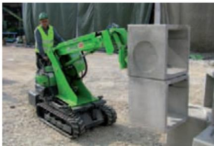
Un agile strumento di lavoro dalle prestazioni sorprendenti che può essere equipaggiato con varie attrezzature (pale, forche, pinze, benne) per scavare, sollevare, caricare, trasportare, movimentare. È compatibile con il sistema di aggancio rapido.
