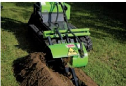
La catenaria è la più piccola e robusta scavatrice nel suo genere e permette di effettuare piccoli scavi per la posa in opera di tubi di irrigazione o cavi elettrici. È compatibile con il sistema di aggancio rapido.
