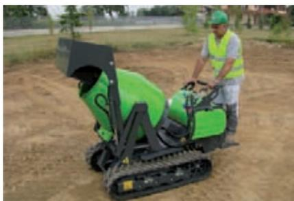
Per aumentare la produttività provvedendo direttamente al carico degli inerti. È compatibile con il sistema di aggancio rapido.
