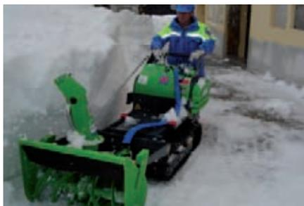
Ad azionamento idraulico dispone di eiettore a turbina con direzione di lancio selezionabile manualmente in continuo. È compatibile con il sistema di aggancio rapido.
