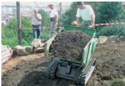
Ideale per il trasporto di materiali sfusi e per lo scarico di precisione.
