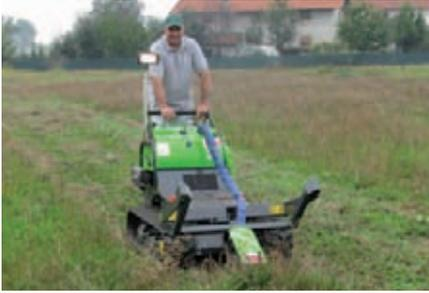
Un sistema avanzato ad azionamento idraulico per lo sfalcio di precisione. La funzione flottante della barra permette il taglio seguendo le asperità del terreno. È compatibile con il sistema di aggancio rapido.
