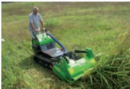
Ideale per la trinciatura di residui di potature, stocchi, piccoli arbusti e per la pulizia di scarpate e sentieri. È compatibile con il sistema di aggancio rapido.
