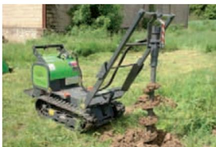
Per eseguire con precisione e senza fatica fori nel terreno per alloggiare pali, sostegni, mettere a dimora giovani piante. È compatibile con il sistema di aggancio rapido.
