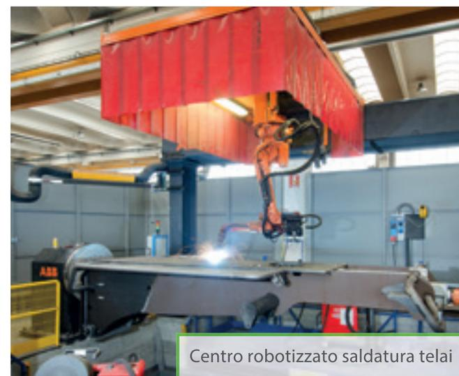
Centro robotizzato saldatura telai
