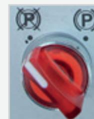
Selettore del freno di stazionamento manuale, il cui inserimento automatico avviene allo spegnimento del motore.
