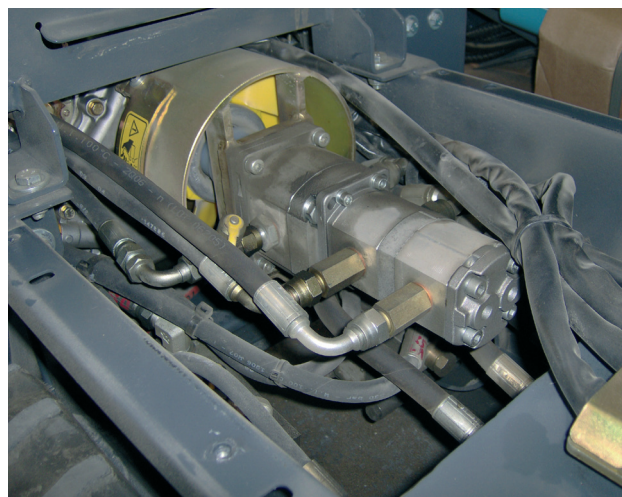
Dettaglio del sistema di raffreddamento olio idraulico (brevettato) / Détail du système de refroidissement huile hydraulique (brevété) / Detalle del sistema de refrigeración aceite hidráulico forzada (patentado)
