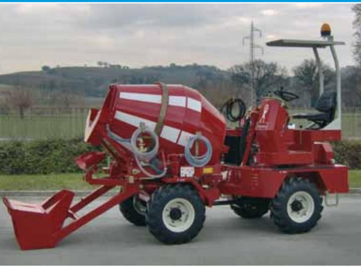
Dumper-Betoniera in posizione di carico inerti. L'operazione avviene controllando l'avanzamento della macchina verso il cumulo di inerti fino al riempimento della pala, che va sollevata alla massima altezza per procedere allo scarico degli inerti all'interno della botte. L'operazione va ripetuta fino al raggiungimento del quantitativo richiesto. L'impiego della trasmissione idrostatica rende l'operazione di carico notevolmente più veloce e sicura.
