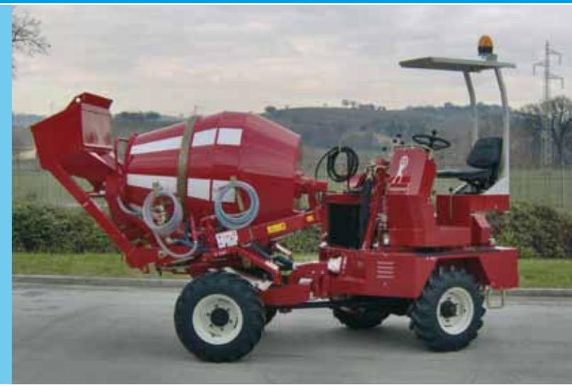
La macchina è munita di un posto di guida girevole, per lavoro e trasferimento con selezione automatica della sterzatura; inoltre è equipaggiata con un cilindro oleodinamico di sollevamento che consente di portare la botte in piano per un più facile scarico di impasti particolarmente asciutti.
