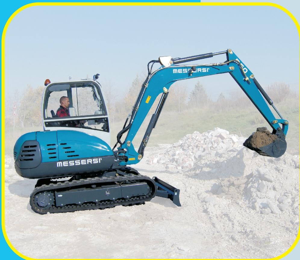
\* Motorizzazione da 2400 cm<sup>3</sup> per 45 Hp di potenza conforme alla Norma 97/68/EC Stage 3
