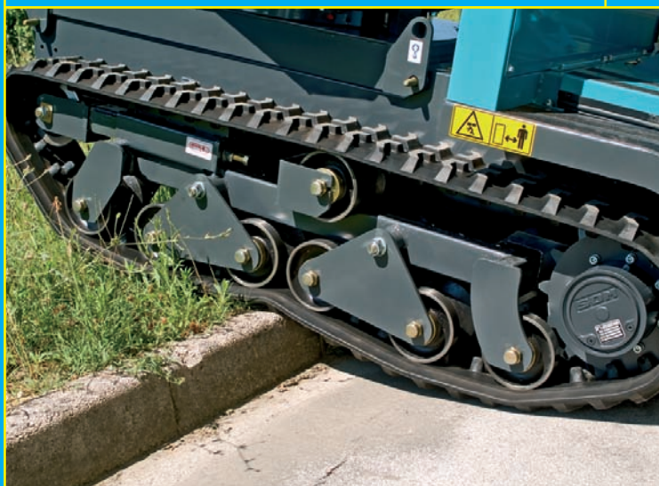
Dettaglio oscillazione cingolo / Détail de l'oscillation de la chenille / Detalle de la cadena articulada
