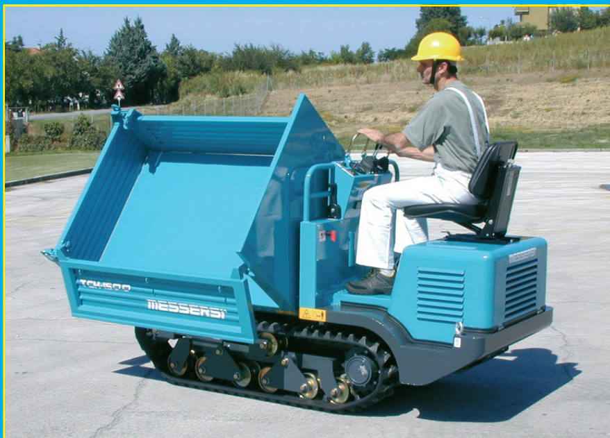
Pianale sollevato / Caisson plat soulevé / Plataforma con descarga en los tres lados
