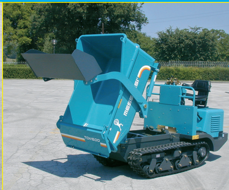
Benna ribaltamento frontale con (senza) pala autocaricante Benne à basculage frontale avec (sans) pelle autochargeuse Contenedor con descarga in altura con (sin) pala para autocarga
