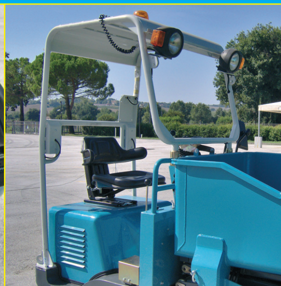
Protezione operatore ROPS-FOPS omologato su strada / ROPS-FOPS canopy (aussi pour circulation routière) / ROPS-FOPS protección (y para el uso sobre carretera)
