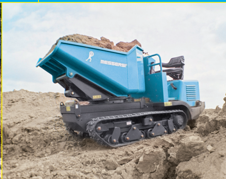
TCH-1500/BT in fase di lavoro / Benne trilaterale TCH-1500/BT en phase de travail / Dumper con descarga mediante rotación de 180° grados TCH-1500/BT trabajando
