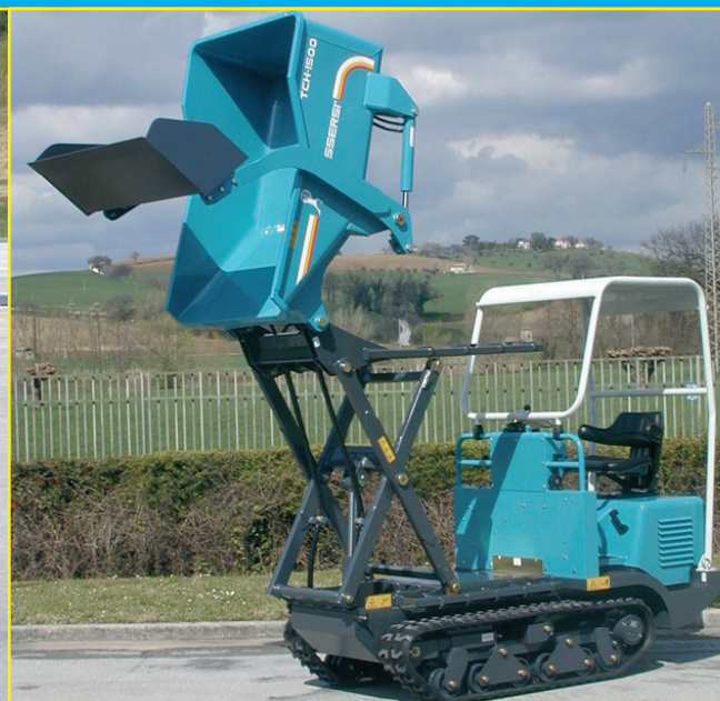
Benna con scarico ad altezza variabile con (senza) pala autocaricante / Benne avec déchargement à hauteur variable avec (sans) pelle autochargeuse / Contenedor con descarga en altura con (sin) pala para autocarga
