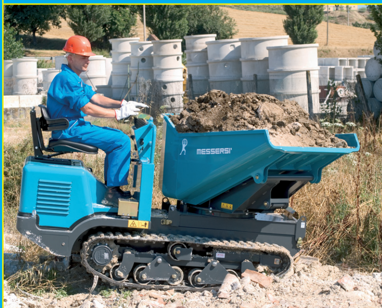
TCH-1500/BT in fase di lavoro / Benne trilaterale TCH-1500/BT en phase de travail / Dumper con descarga mediante rotación de 180° grados TCH-1500/BT trabajando
