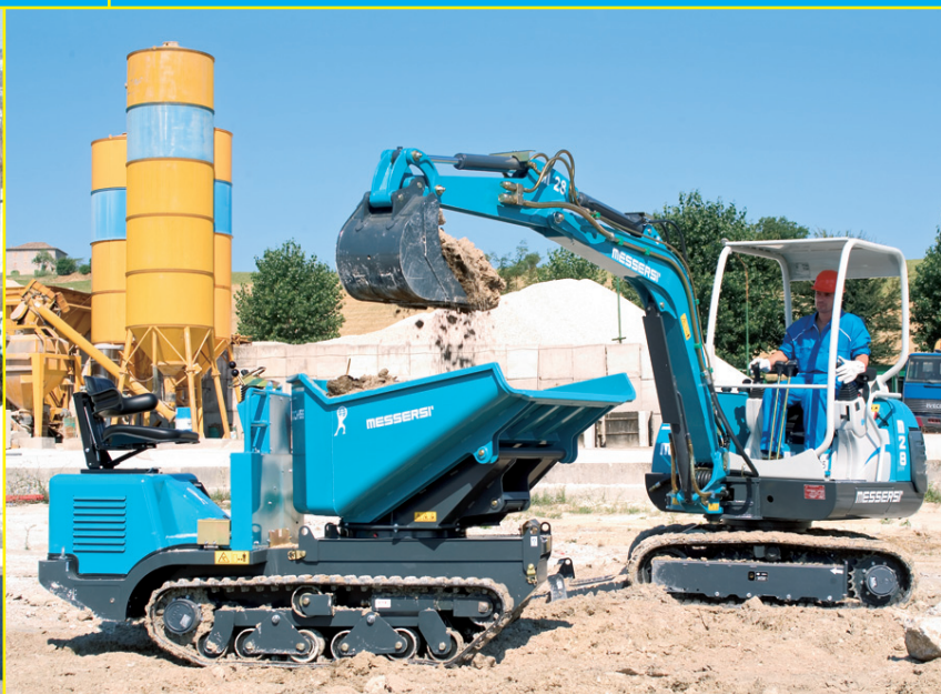
Benna ribaltamento frontale con (senza) pala autocaricante Benne à basculage frontale avec (sans) pelle autochargeuse Contenedor con descarga in altura con (sin) pala para autocarga
