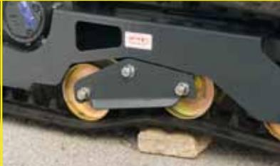
Dettaglio oscillazione cingolo / Détail de l'oscillation de la chenille / Detalle de la cadena articulada
