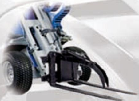
Pinza idraulica per forca pallet
